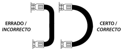
Para evitar o colapso e a restrição de fluxo, conserve o raio de curvatura o maior possível. Consultar as tabelas de especificações para obter o raio mínimo de curvatura.
