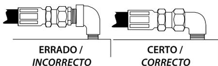
Reduzir o nº de uniões rosca cano pelo uso apropriado de adaptadores hidráulicos ao invés de roscas cano.
