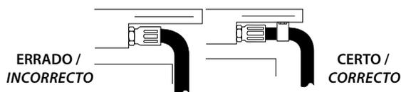
Na instalação da mangueira evite o friccionamento e abrasão. Frequentemente abraçadeiras são necessárias para suportar mangueiras longas ou para manter a mangueira longe das partes móveis. Use abraçadeiras do tipo correto. Com uma abraçadeira muito longa a mangueira se moverá dentro dela causando abrasão da cobertura.
