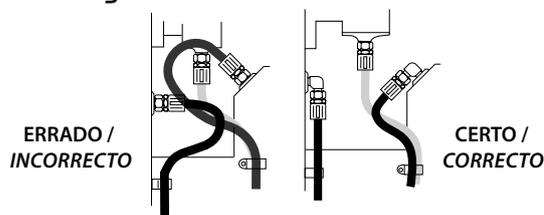
A rota de instalação das mangueiras são facilitadas com o uso de terminais e adaptadores curvos 45° e 90°. Evitando assim, comprimentos excessivos das mangueiras e melhora da aparência.
