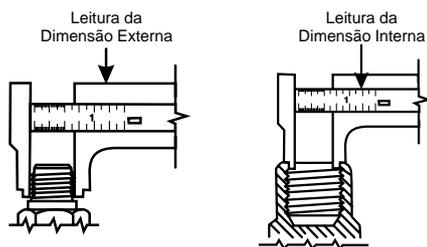
Com o paquímetro meça o diâmetro da rosca no maior ponto. (Diâmetro externo (DE) para rosca macho e diâmetro interno (DI) para rosca fêmea.)
