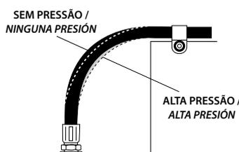
Para seguir as mudanças no comportamento quando a mangueira é pressurizada, não coloque abraçadeiras nas curvas. Não coloque também abraçadeiras nas linhas de pressão variável.
