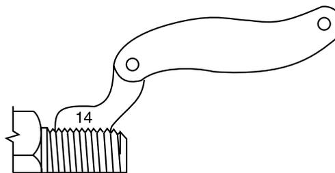
Utilizando o calibre de rosca, determinamos o número de fios por polegada. Basta calibre sobre a rosca da terminação contra um fundo iluminado e obter uma leitura exata.
