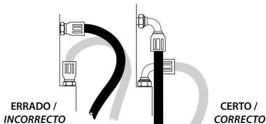
Cotovelos e adaptadores devem ser usados para compensar deformações nos conjuntos, e dar melhores instalações as quais serão mais acessíveis para instalação e manutenção.
