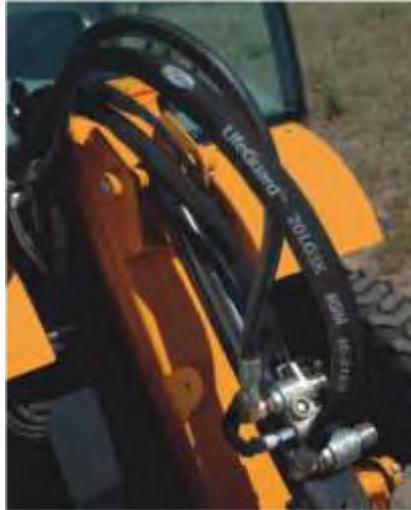
O sistema LifeGuard™ reteve com eficiência os fluidos no teste de rompimento de 10,000 psi (68,9 MPa) enquanto as mangueiras sem proteção estouraram, liberando grande quantidade de fluido na área de teste.
