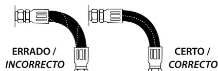
Quando da instalação da mangueira, certifique-se de que ela não está torcida. Pressão aplicada em uma mangueira com torção pode resultar numa falha da mangueira ou afrouxamento das conexões.
