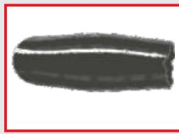
O óleo é o pior inimigo de uma mangueira de borracha. Uma mangueira contaminada com óleo apresenta-se inchada e amolecida. Caso isso ocorra, a mangueira deverá ser substituída e o vazamento de óleo contido.
