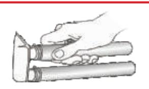
**DICA:** Colocar primeiro a abraçadeira e em seguida a mangueira. Isso facilita a sua instalação uma vez que no bocal há um ressalto para assegurar que a mangueira não escape.
