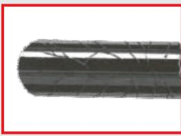
O Ozônio causa minúsculas fissuras, dispostas em pequenas linhas paralelas em toda a extensão da mangueira. **As mangueiras Gates são fabricadas com um composto chamado EPDM,** que resiste completamente ao ozônio (por tratar-se de um elastômero saturado).
