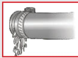
Rachaduras presentes nas bordas das mangueiras são resultado, em geral, de abraçadeiras apertadas em excesso ou posicionadas de forma incorreta sobre o bocal. A instalação correta da mangueira é primordial para se obter o melhor desempenho do sistema de arrefecimento.
