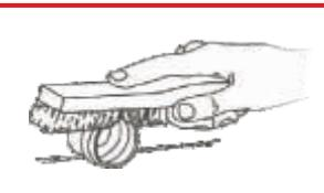
**Verificar bocal:** É preciso verificar o bocal quanto à corrosão ou rebarbas. Isto pode danificar a mangueira e dificultar a estanqueidade do sistema. Para a retirada de resíduos, deve-se limpar o bocal utilizando uma lixa ou escova metálica. **Nota: Cuidado redobrado com bocais plásticos!**
