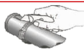
**Mangueira "colada" no bocal:** a maioria das mangueiras soltam-se com facilidade, assim que a abraçadeira é desapertada. Caso isso não ocorra, gire a peça ao redor do encaixe, deslizando a mesma sobre essa superfície. Se ainda assim, a mangueira não se soltar, a mesma deve ser cortada quando for substituída.
